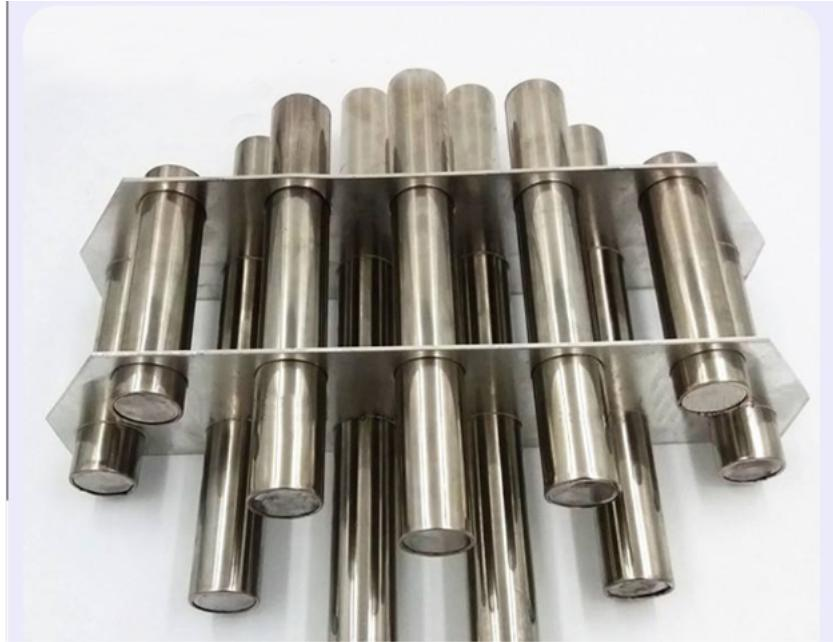
RCYB系列悬挂式永磁除铁器内部采用高矫顽力，高剩磁的特殊永磁体“钕铁硼”等材料组成复合磁系。具有免维护、磁力强、寿命长、安装简单、使用方便、运行可靠等特点，适用于皮带机、振动输送机、电磁振动给料机、下料溜槽上的非磁性物料中除铁。去除0.1~35公斤的铁磁性物质，内部永磁磁系使用寿命10年以上。当永磁铁吸附铁磁物较多时，人工用非磁性刮板去除或戴手套摘除，适用于连续工作，含铁较少的场合。技术特点：1、采用高矫顽力、高剩磁的永磁体钕铁硼等组成复合磁系，磁场强、吸力大。2、安装简单、使用方便，运行可靠，免维护。3、各项技术指标均符合JB/T8711-2006。悬挂式除铁器市场价多少？使用寿命多久？赣州强磁除铁器
